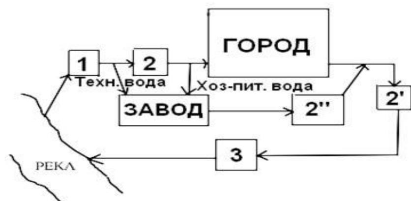
1 – водозабор города; 2, 2' – очистные сооружения города; 2'' – очистные сооружения заводские; 3 – биологические пруды
