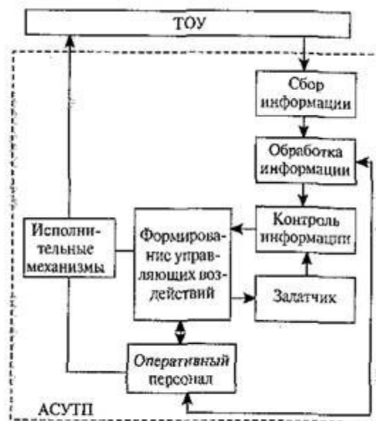
Рис. 70. Обобщенная функциональная структура АСУТП
