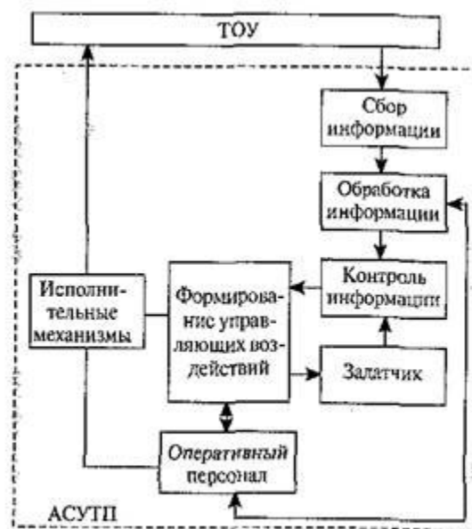
Рис. 70. Обобщенная функциональная структура АСУТП
