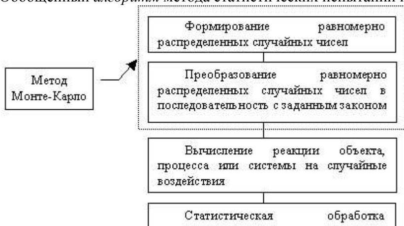
Рисунок 1. Обобщенный алгоритм метода статистических испытаний
