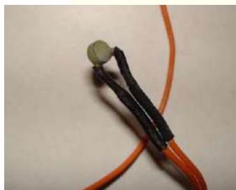
Рис.3 - Атом индия в решетке германия. Рис.4 – Внешний вид терморезисторов
