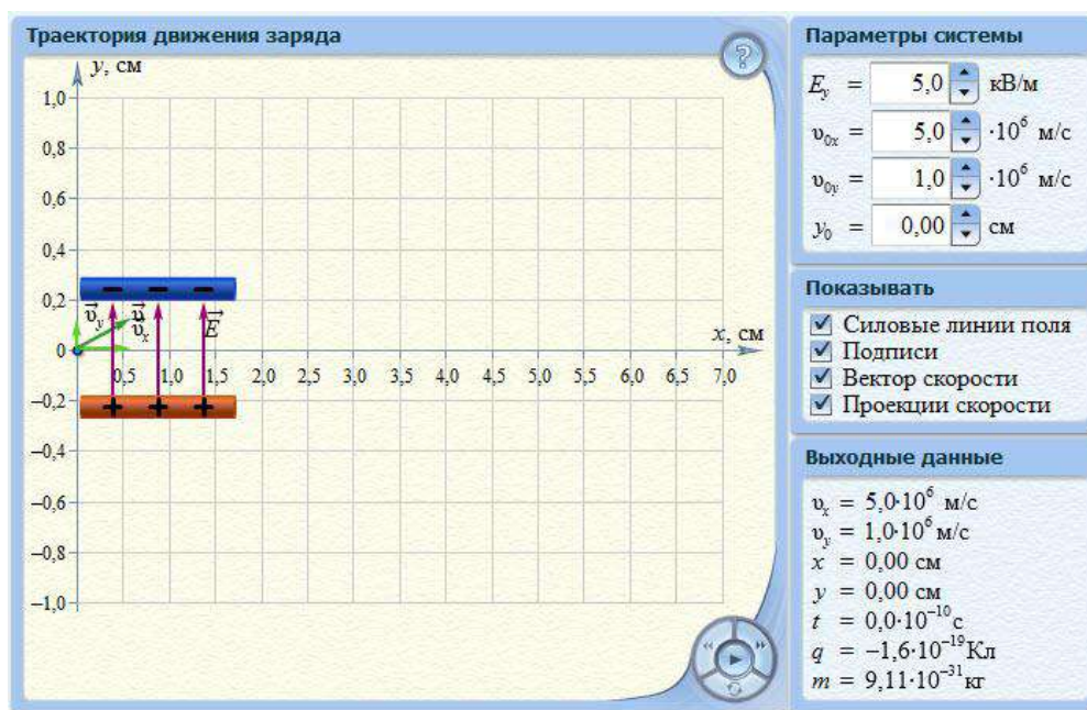
Модель движения заряда в однородном электрическом поле
