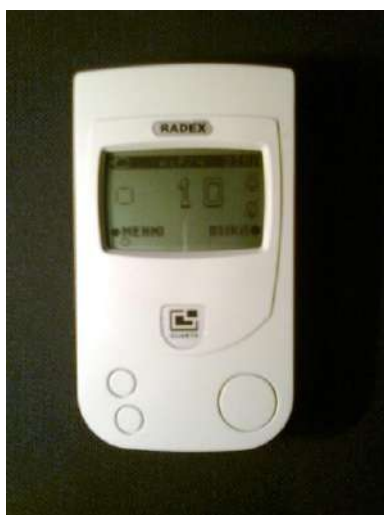
Рис.5 – Внешний вид индикатора радиоактивности «Радекс»
