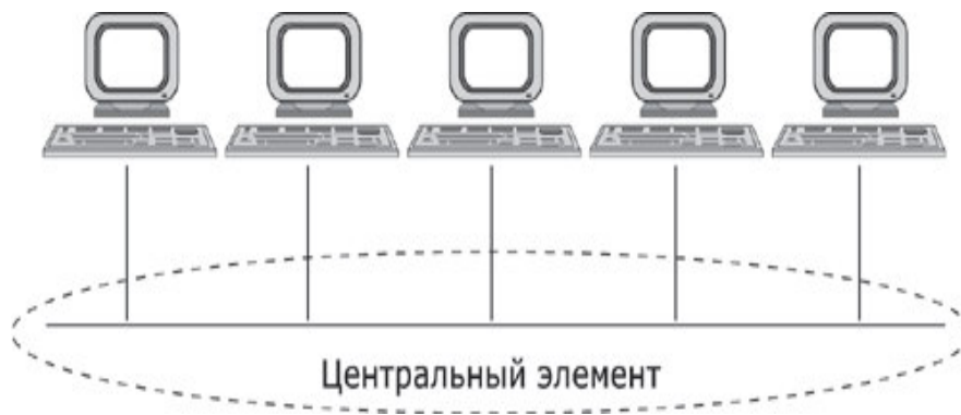
Рисунок 7 - Топология "общая шина"
