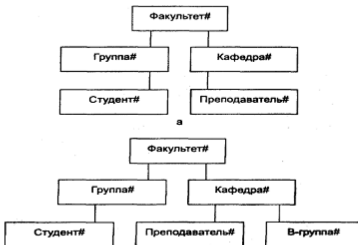
Рис. 3.16 Иерархическая база данных для вуза: а - исходная структура; б - с добавленными сведениями о группах дипломников.
