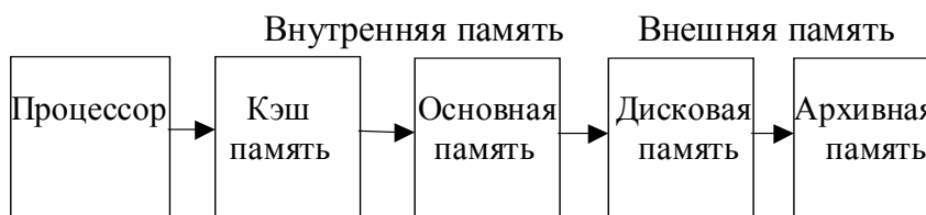
Рис. 1. Иерархическая структура памяти
