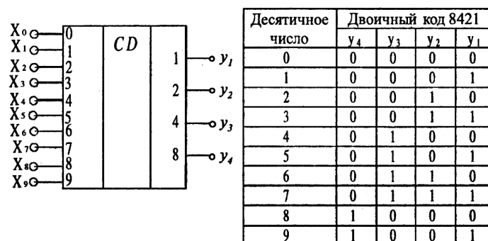
Рис. 15. Схема шифратора и таблица соответствия кода
