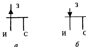
Рис. 14. Графическое изображение полевого транзистора:
