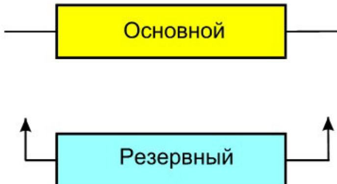
Схема а). При постоянном включении резервный элемент включен параллельно основному и работает вместе с ним. При отказе основного элемента установка сохраняет работоспособность за счет резервного элемента, принимающего на себя всю нагрузку. В
