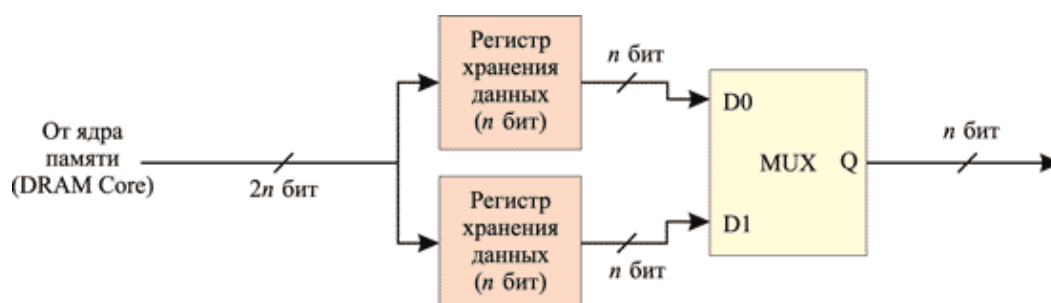
Рисунок 2.7 – Реализация технологии 2n-Prefetch
