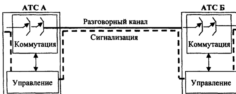
Рисунок 3 - Сигнализация по выделенному сигнальному каналу с отдельными блоками коммутации и управления
