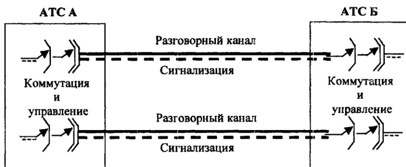
Рисунок 2 - Сигнализация по телефонному каналу
