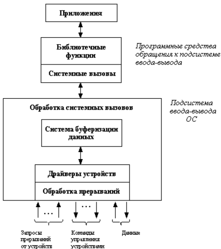
Рис. 2.30. Многоуровневая организация подсистемы ввода-вывода Обработка прерываний
