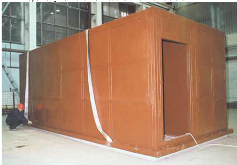
Рисунок 2.8 - Мобильная (перевозимая) экранированная камера
