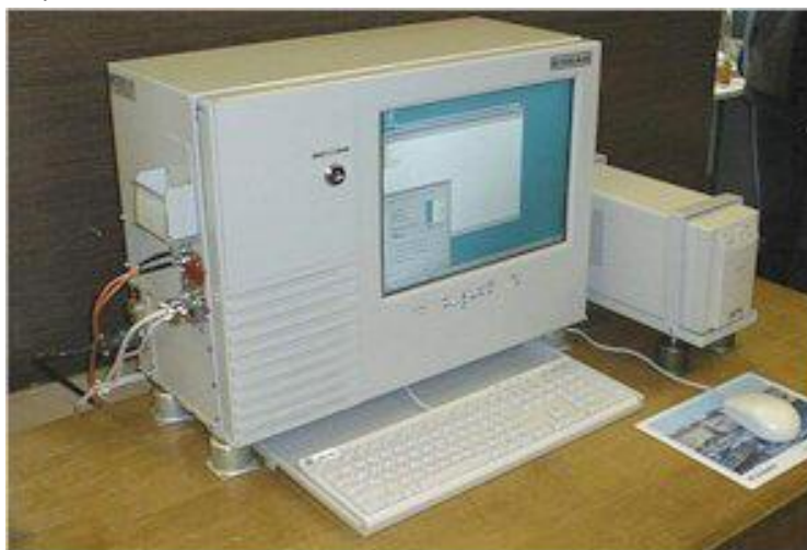
Рисунок 2.2 - ПЭВМ«ЕС1855.М.02» в специальном защищенном исполнении
