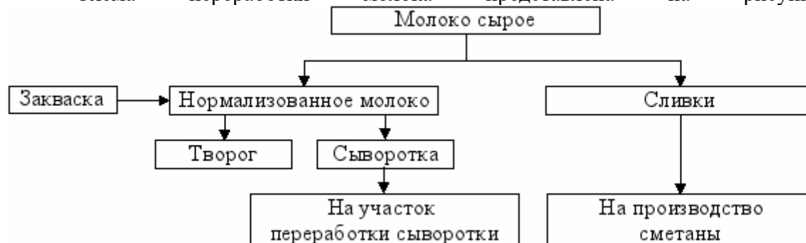
Рисунок 2 – Схема переработки молока при выработке творога традиционным способом
