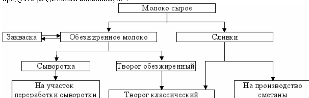
Рисунок 3 – Схема переработки молока при выработке творога раздельным способом
