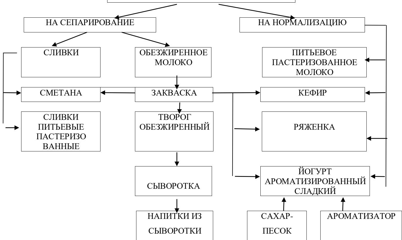
Рисунок 3.1 Схема направлений переработки молока
