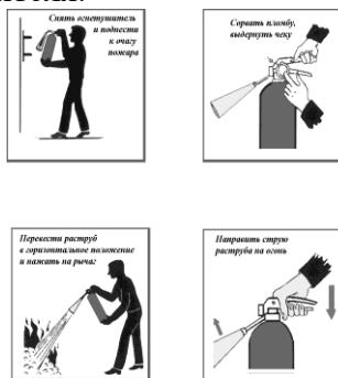
Рис. 8. Приведение в действие ручного углекислотного огнетушителя (показаны)
