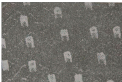
Рис. 1 Материалы с ориентированной структурой: а- НКЭ - сплав; б - монокристалл ЖС36
