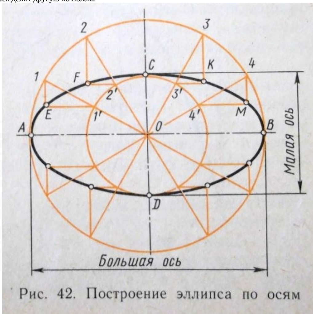
Рисунок 42. Построение эллипса по осям
