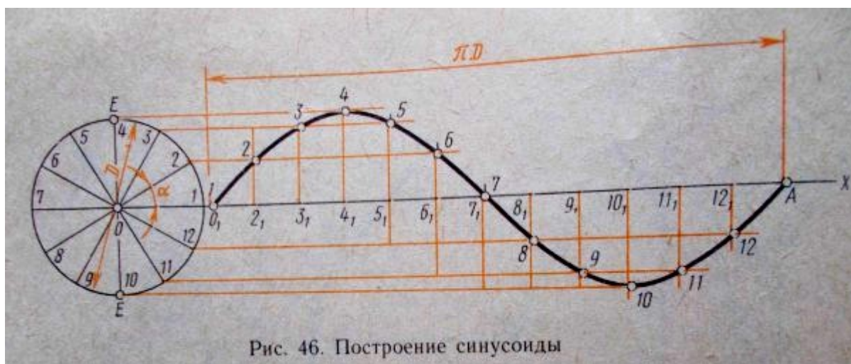
Рисунок 46. Построение синусоиды
