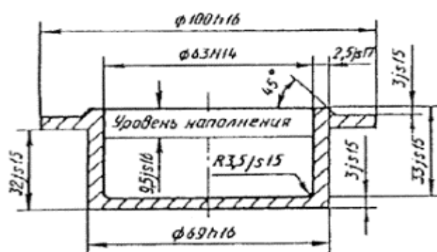
Черт. 1. Устройство для нагревания тигля, обеспечивающее скорость нагревания до 17 °C/мин.
