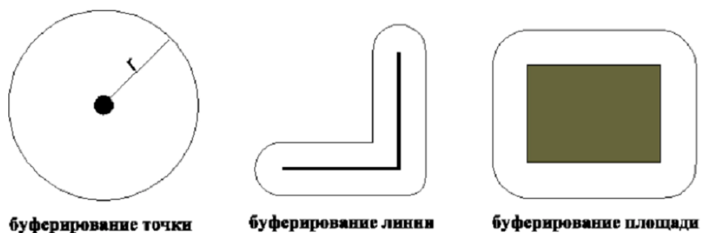
Рисунок 1 - Построение буферных зон заданной ширины для различных графических примитивов
