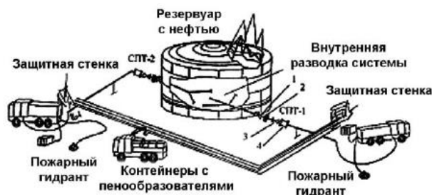
Рис. 13. 9. Принципиальная схема подачи пены низкой кратности при тушении пожара в резервуаре подслоинным способом. 1- задвижка; 2- мембрана предохранительная; 3 – обратный клапан; 4 – пеногенератор.
