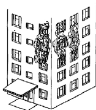
Рис. 2. 22. Схема перехода пожара с нижних этажей на верхние.
