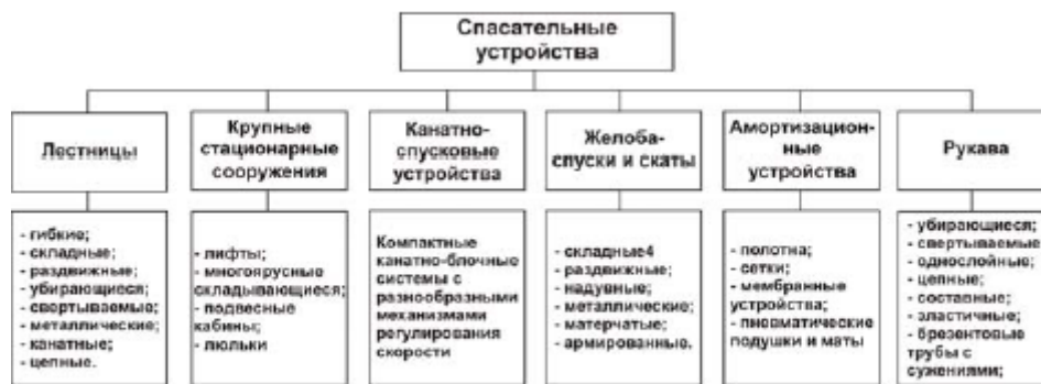
Рис. 11. 2. Классификация спасательных устройств.
