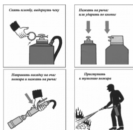
Рис. 9. Приведение в действие воздушно-пенного огнетушителя (планы)
