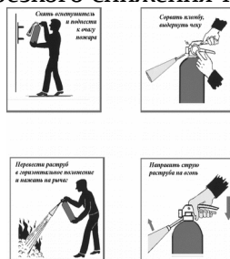
Рис. 8. Приведение в действие ручного углекислотного огнетушителя (планы)
