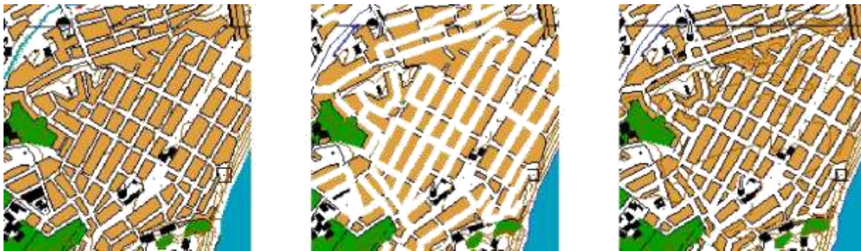
Рис. 49. План квартала крупного населенного пункта до (а) и после (б, в) генерализации: а – показаны кварталы крупного населенного пункта до выполнения формирования проездов; б – белым цветом отмечены расширенные проезды между кварталами; в – показаны кварталы после автоматической обрезки кварталов по расширенным проездам. В целом, мелкие кварталы объединены, ширина проездов увеличена
