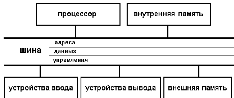
Р и с у н о к 0.2 -- Магистральный (шинный) принцип обмена информацией между модулями
