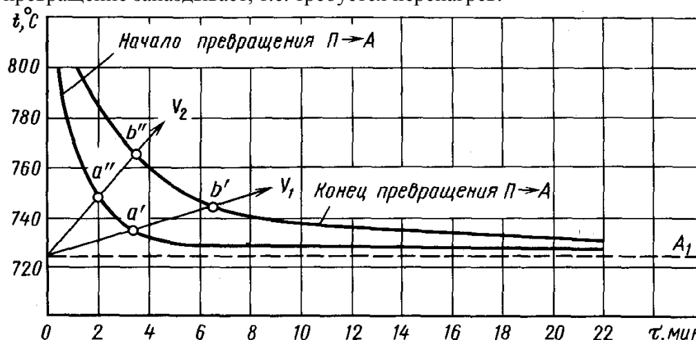
Рис. 2. Превращения перлита (П) в аустенит (А) при постоянной температуре
