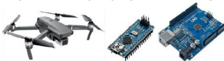
Рис. 1. Базовые технические компоненты для проведения исследования: а – квадрокоптер Mavik 2 Pro; б – микроконтроллер Arduino Nano V3 (для модуля газоанализатора); в – Arduino UNO R3 (для пульта оператора)
