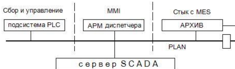
Рис.6 Структура SCADA системы с выделенным сервером.
