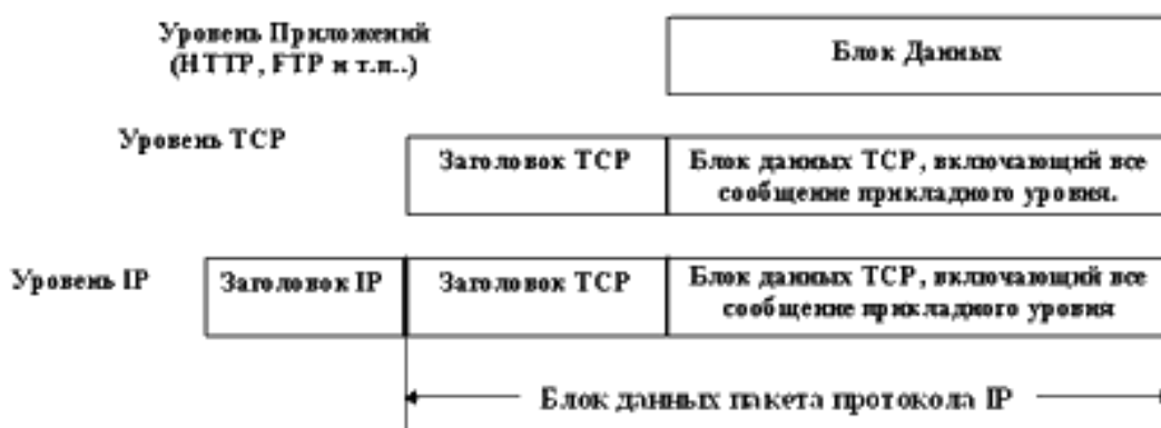
Рисунок 24. Инкапсуляция протоколов верхнего уровня в протоколы TCP/IP
