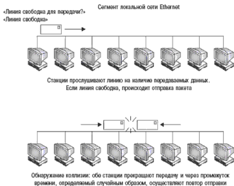
Рис. 1.5. Работа алгоритма CSMA/CD
