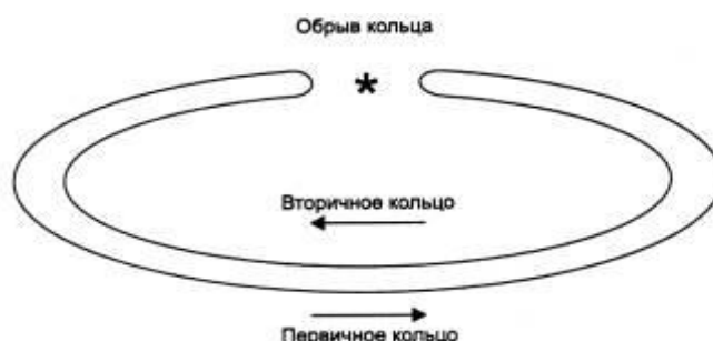
Рисунок 1 - Реконфигурация колец FDDI при отказе
