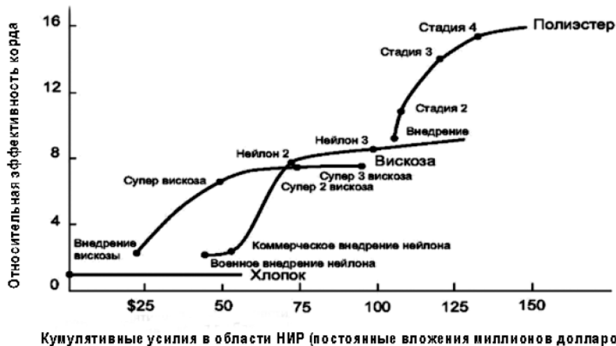
Рисунок 2 Разрывы непрерывности при совершенствовании материалов для шинного корда
