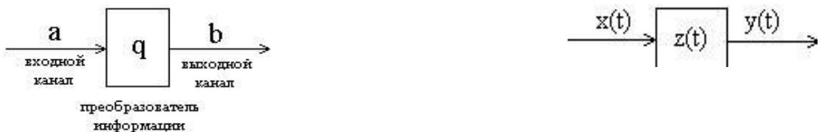
Время работы автомата считается дискретным  $t = 0, 1, 2, 3, \dots$ . Входные, выходные сигналы и состояния автомата являются функциями от времени:  $a = x(t)$ ,  $b = y(t)$ ,  $q = z(t)$ .
