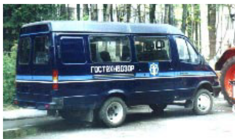
Рисунок 5 – Передвижной пост технического контроля тракторов и самоходных машин КИ-28106 (01,02) на а/м «Газель»
