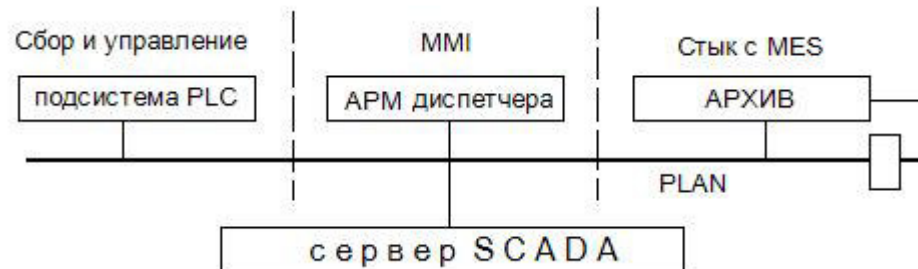
Рис.6 Структура SCADA системы с выделенным сервером.
