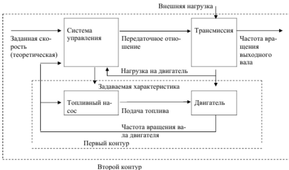
Рисунок 5. Структурная схема двухконтурного управления моторно-трансмиссионной установкой трактора
