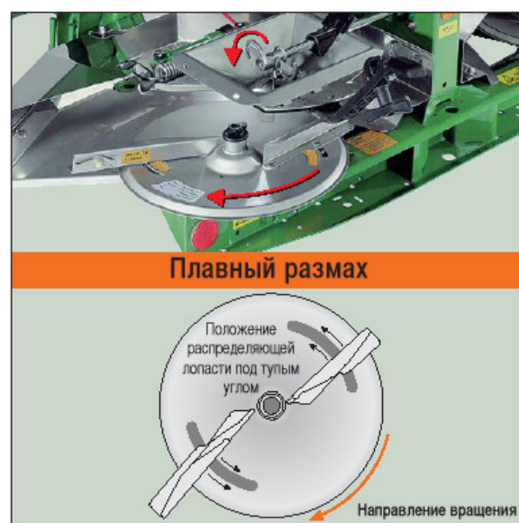
Рис.7.11 Система AMAZONE Soft Ballistic System на скорости 720 об/мин не наносит вреда удобрениям при распределении. Даже сорта удобрений с небольшим пределом прочности сохраняют свойства распределения.
