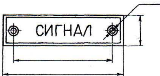
Рис.6. Простановка размеров для нанесения надписи на изделия
