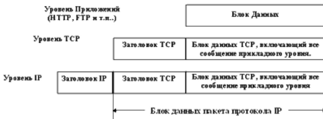
Рисунок 24. Инкапсуляция протоколов верхнего уровня в протоколы TCP/IP
