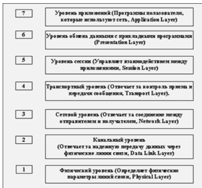
Рисунок 21. Семиуровневая модель протоколов межсетевого обмена OSI
