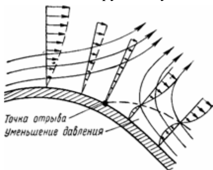
Рис. 8 Течение в пограничном слое вблизи точки отрыва
