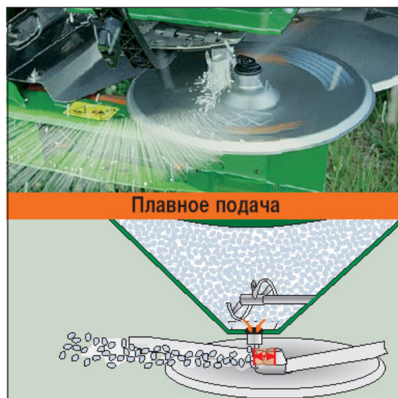
Рис.7.10 Место попадания удобрений по центру распределяющего диска особенно выгодно, так как окружная скорость распределяющих дисков в этом секторе очень низкая
