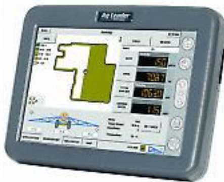
Рис.8.8 Система дифференцированного внесения удобрений «off-line» Insight (DirectCommand) выполняет автоматическое и ручное управление нормой внесения и дифференцированное внесение жидких удобрений по электронным картам.
