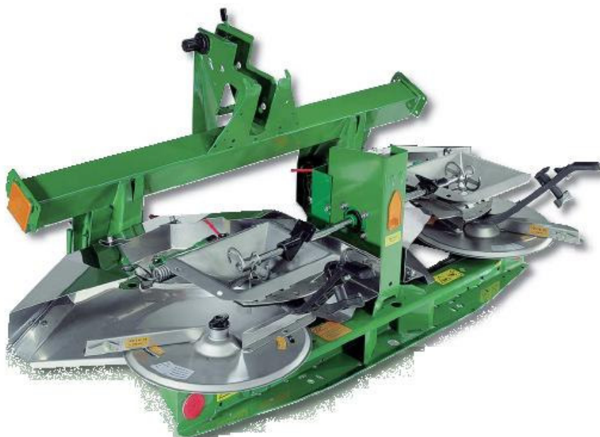
Рис.7.18 Представлено внутреннее устройство распределяющего механизма разбрасывателя ZA-M 1500
