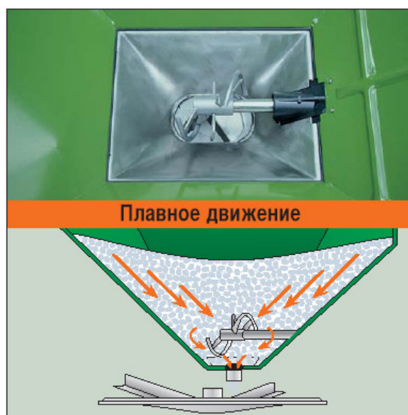
Рис. 7.9. Посередине бункера нет воронковидного наконечника
