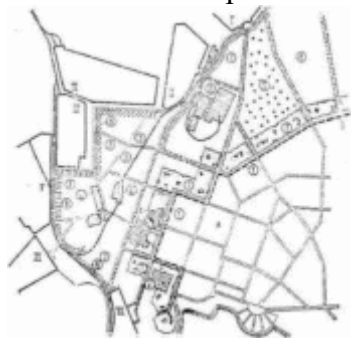
Рис. 18. Примерная схема планировки санитарно-защитной зоны в условиях реконструкции города и промышленных предприятий (Из практики проектирования ЦНИИПромзданий)
