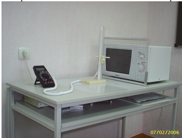
Рис. 1 Стенд лабораторной установки излучающий электромагнитные колебания частотой 2400 МГц, и длиной волны \lambda = 12,5 см = 0,125 м) и координатное устройство.
