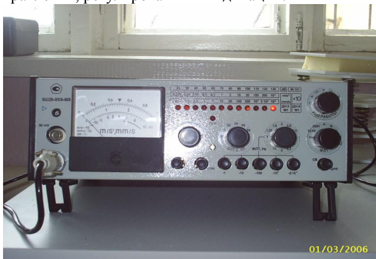
Рис.4 Измеритель шума и вибрации ВШВ-003-M2 переключатель РОД РАБОТЫ с положениями:
