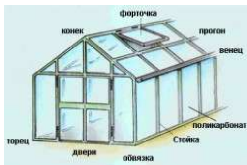
Рис.10 Схема деревянной теплицы из поликарбоната
