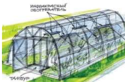
Рис. 14 Схема теплицы с инфракрасным освещением.
