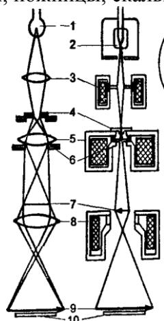
Рис. 1. Устройство светового и электронного микроскопов (а), окулярный (б) и объективный (в) микрометры:
