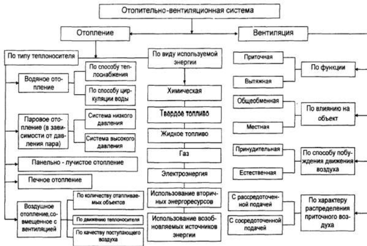
Рис. 1 Классификация отопительно-вентиляционных систем
