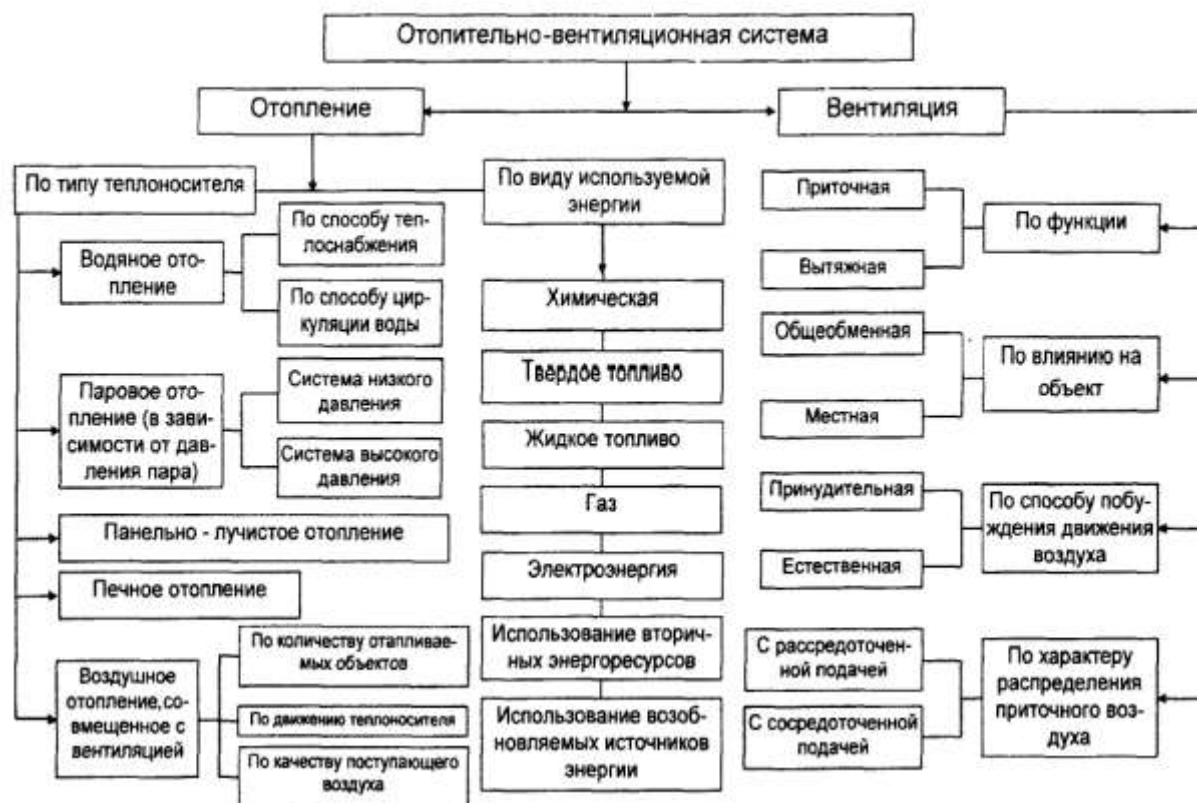
Рис. 1 Классификация отопительно-вентиляционных систем
