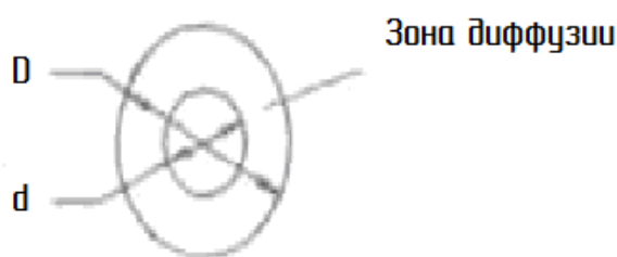
Рисунок 4.14 Схема расчета диспергирующей способности масла
