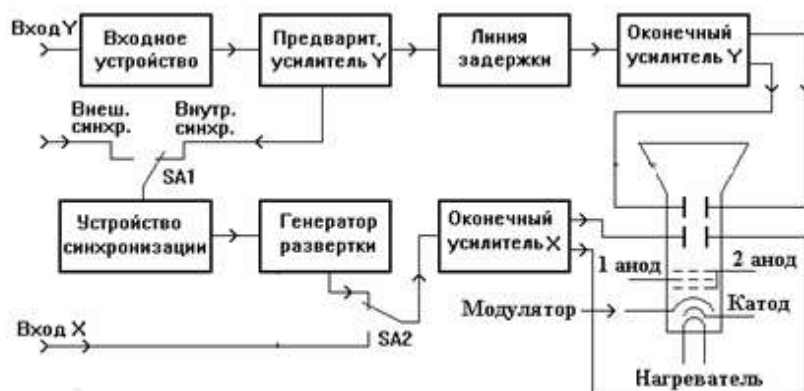
Рис.1 – Структурная схема осциллографа (базовая модель)
