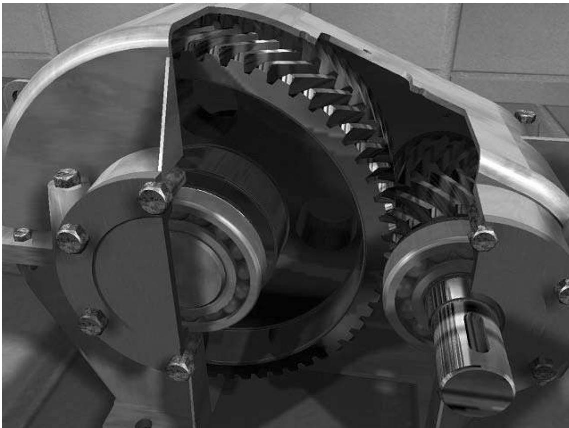
Рис. 2.79. Одноступенчатый цилиндрический шевронный редуктор (корпус в разрезе) Исходные данные
